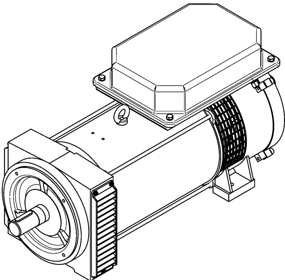
› Serie SDB, Schutzklasse IP 23, innenbelüftet, mit Eigenlüfter
